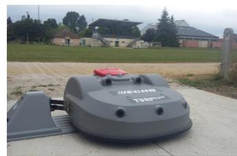
Un robot de tonte de marque ECHO vient d'être déployé sur les terrains de foot. Fini les nuisances sonores ! Entièrement programmable et commandé par signal GPS, il peut tondre un terrain en moins d'une journée,
